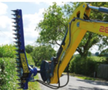
ONE-TP, spécialiste en équipements pour engins TP, propose des taille-haies hydrauliques adaptables sur mini pelles. Destinés aux engins d'1,5 à 11 t, ces outils de fabrication irlandaise possèdent un diamètre de coupe de 40 mm, voire 50 mm, et sont disponibles en différentes longueurs : 1 500/1 800/2 200 mm. Options disponibles : renvoi d'angle mécanique de 90°, bras d'extension de 1 000 mm, cardan de fixation sur attaches rapides...
