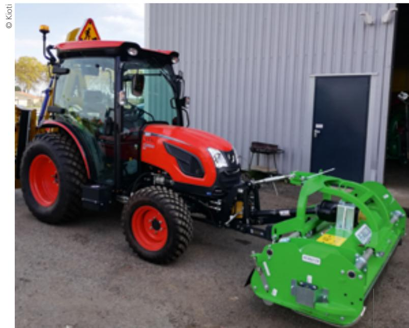
**Le tracteur DK6010 HST de Kioti affiche des caractéristiques intéressantes : une prise de force 540 tr/min à enclenchement automatique en fonction de la hauteur de relevage, deux pédales HST côte à côte avec trois gammes de vitesses...**
