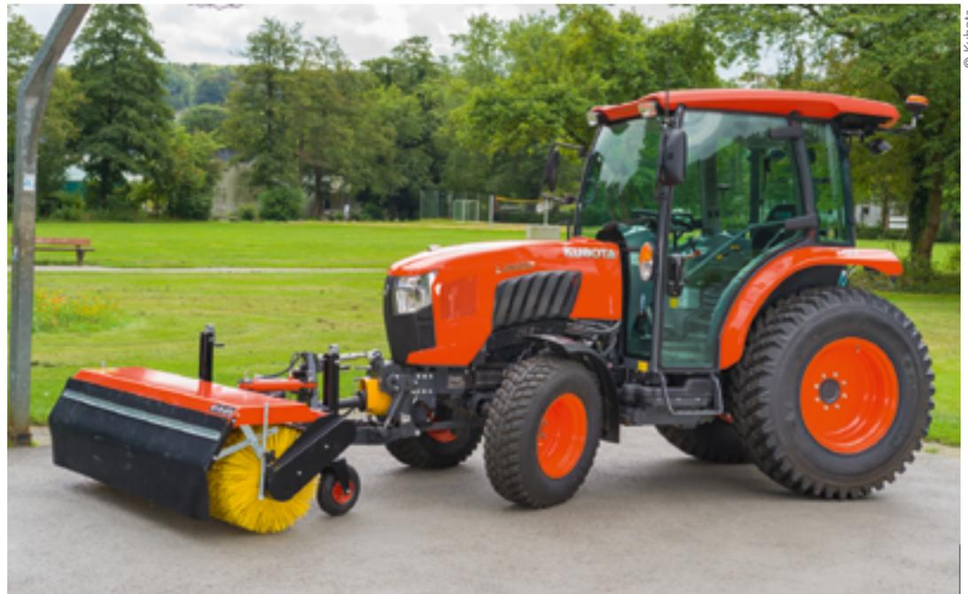
**Avec son moteur de 60 ch et sa cabine 20 % plus spacieuse, le nouveau tracteur compact Kubota L2 60 2 bénéficie de nouvelles fonctionnalités au monolevier pour encore plus de confort au travail. En série, distributeurs hydrauliques double effet et un additionnel en option pour assurer un maximum de polyvalence.**
