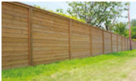
Jacksons clôtures présente le mur acoustique, disponible en deux versions : réfléchissant ou absorbant. Les planches de 4,8 m se montent par emboîtement les unes sur les autres. Ce système de mur permet de passer de 70 à 60db. Il est garanti 25 ans contre le pourrissement et les insectes.
