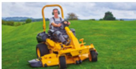
Puissance étonnante et confort inégalé - la combinaison parfaite pour les vrais professionnels ! La Z7 183 de Cub Cadet offre des performances, une qualité et une efficacité supérieures grâce à ses 183 cm de largeur de coupe et son moteur Kawasaki de 31 cv. Transmission : double groupe hydrostatique. Hauteur de coupe : 2,6 à 12,7 cm. Type d'éjection : latérale, mulching inclus.
