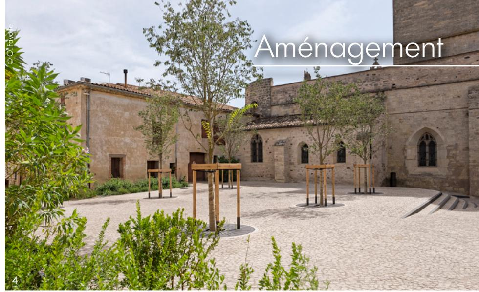
3/ Le revêtement calcaire se compose d'éclats de dalles jointés, d'environ 6 à 8 cm de long, et de bordures basaltes, en saillie d'environ 2 cm.
