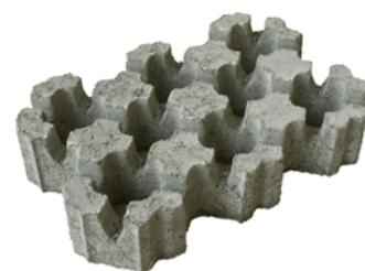
Résistant et adapté à tous les concepts actuels de réalisations, le dallage drainant Dalpré Fabemi prévient les risques d'inondations en absorbant les eaux de pluie. À combler avec du gazon ou du sable, ce module en béton supporte une circulation intense (classe de trafic T3-4) dans la limite de 150 véhicules par jour. Le dallage drainant Dalpré, de 50 x 33 cm, doit être posé sur sable ou gravillon pour des ouvrages divers (parkings, places piétonnes, routes à trafic limité...).
