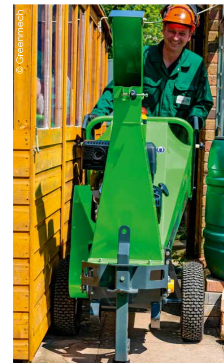
Le broyeur Greenmech CS100 mesure 76 cm de large, ce qui lui permet de passer facilement dans de minces couloirs.
