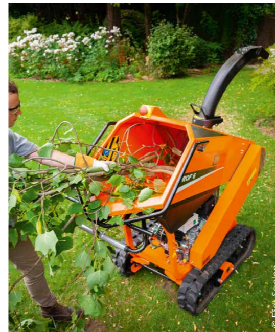
Sur chenilles, le broyeur Prof 6 cross country passe de partout. Cette machine, distribuée par Saelen, 'hache' les branches de 10 cm de diamètre grâce à 24 couteaux.
