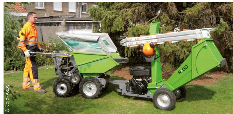
D'un poids de 184 et 195 kg (selon le modèle) et monté sur deux grandes roues en caoutchouc (pouvant en option être jumelées), le broyeur Rajo R-GO™, distribué par Axco, se déplace sans abîmer les surfaces délicates. Deux couteaux réversibles hachent les branches de 130 mm de diamètre au maximum (90 mm de diamètre garanti pour la version 18 cv).
