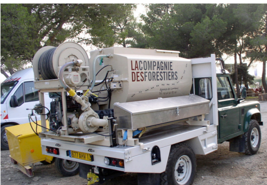
Pour réaliser les 10 000 m 2 d'enherbement par hydroseeding, l'entreprise a son propre matériel : une cuve de 1 000 L et une lance. Cette technique est en effet courante sur les chantiers de génie écologique.
