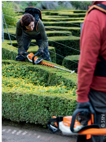
Le taille-haies HSA 94 de Stihl est équipé du moteur 'intelligent' EC Stihl et d'une fonction d'inversion automatique du sens de rotation. Une simple pression sur la gâchette de commande du taille-haies suffit pour changer le sens de la coupe et permet ainsi de débloquer immédiatement les lames.
