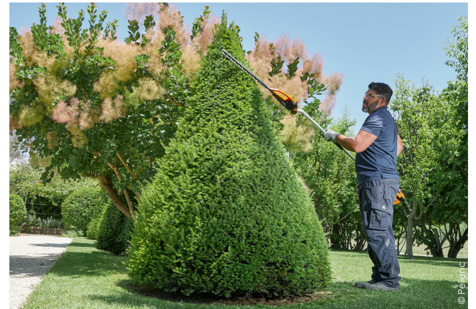
Dans la gamme Alpha, Pellenc propose le taille-haies Helion, qui est doté d'un centre de gravité optimal. Sa batterie 260 embarquée en fait un outil toujours prêt à l'emploi pour une durée de travail allant jusqu'à 4 h.
