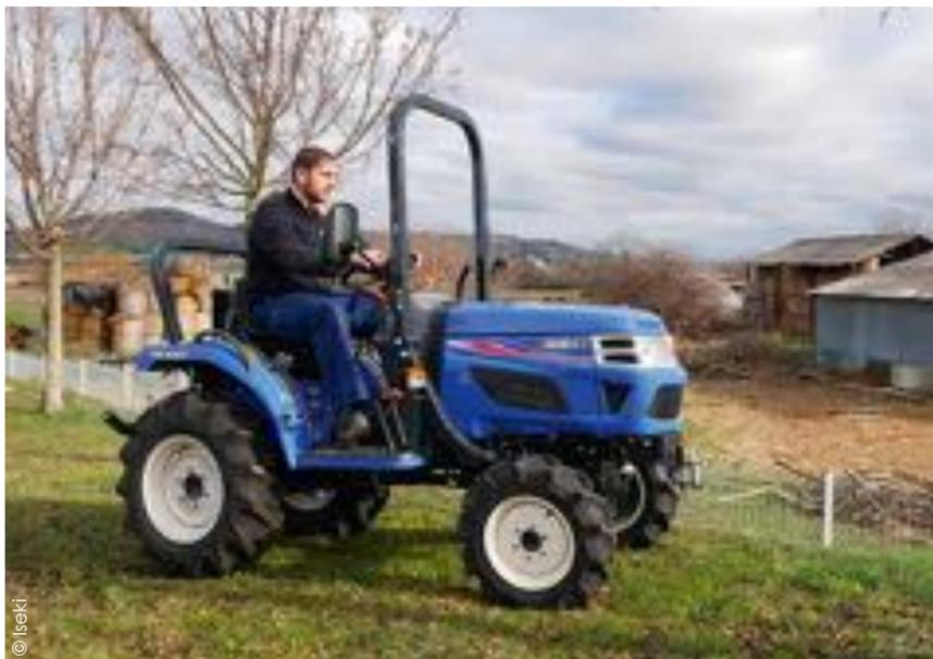
Disponible en version mécanique ou hydrostatique, le tracteur compact TM3267 d'Iseki dispose notamment d'une plateforme flottante, amortissant les vibrations, d'un réservoir de grande capacité (28 L), d'un 'cruise' contrôle (régulateur de vitesses)...
