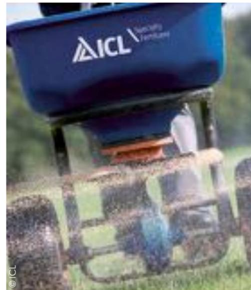
Le groupe ICL propose des épandeurs manuels, montés sur roues gonflables (Accupro 1000, Accupro 2000) pour épandre toutes leurs gammes d'engrais sur de petites et moyennes surfaces.
