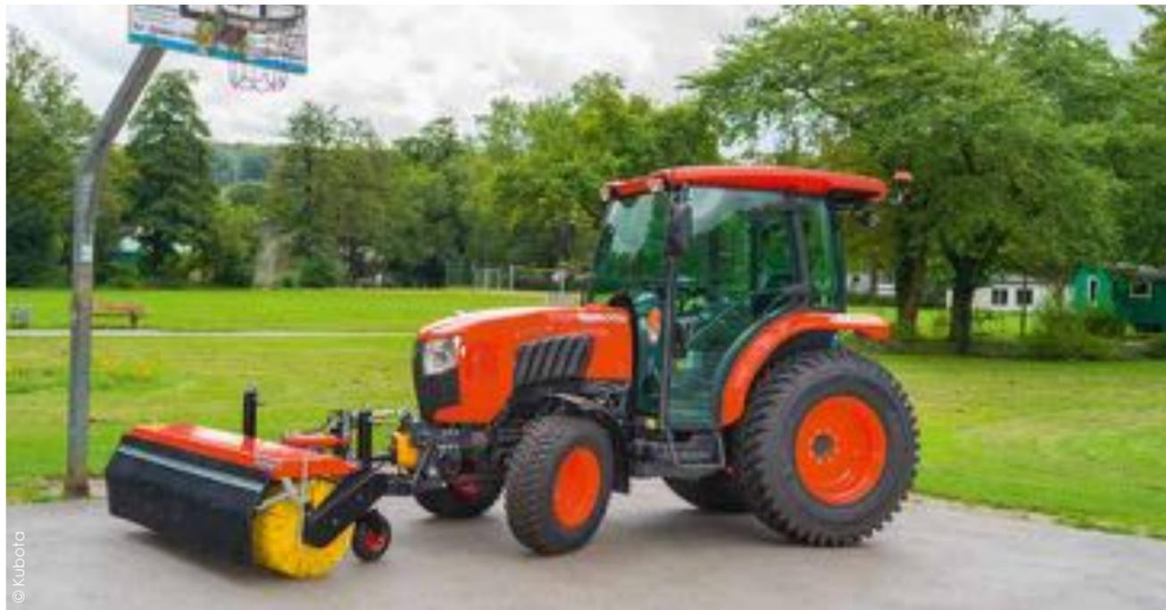
Avec son moteur de 60 ch et sa cabine 20 % plus spacieuse, le nouveau tracteur compact Kubota L2 60 2 bénéficie de nouvelles fonctionnalités au monolevier pour encore plus de confort au travail. En série, distributeurs hydrauliques double effet et un additionnel en option pour assurer un maximum de polyvalence.
