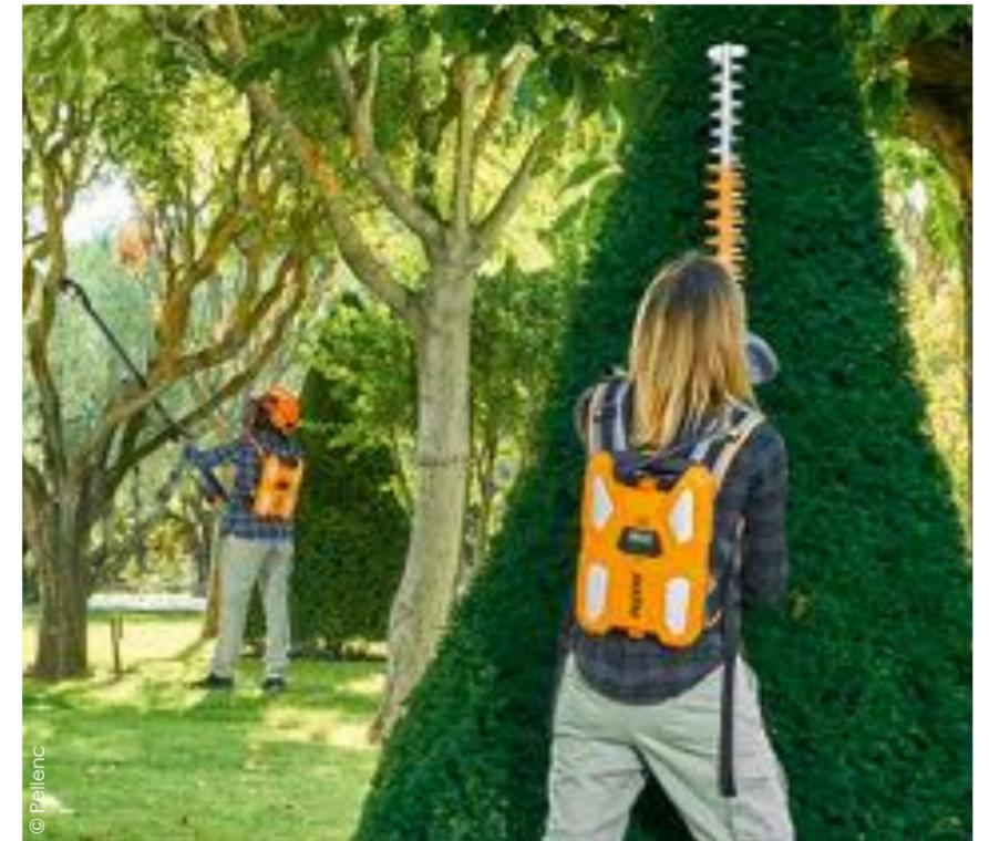
Proposée par Pellenc, la nouvelle batterie dorsale UliB 750 est faite pour les élagueurs. Sa faible épaisseur et sa compacité assurent une grande liberté de mouvement dans les arbres. Elle permet d'effectuer un travail équivalent à l'utilisation de 4 500 L d'essence et 67,5 L d'huile de mélange.
