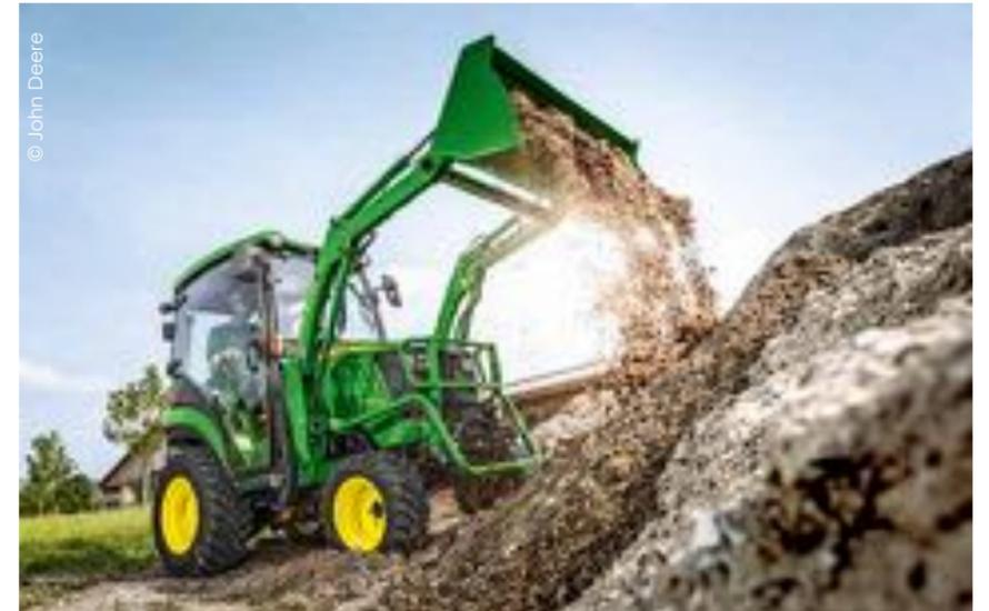
Le tracteur 2026R de John Deere se caractérise par un moteur 3 cylindres de 1 115 cm<sup>3</sup>, développant 26 CV. La transmission hydrostatique est commandée par les pédales jumelles 'Twin Touch'™ (une pédale MAV, une pédale MAR). Sa capacité de levage est de 400 kg (à 610 mm des bras de relevage).
